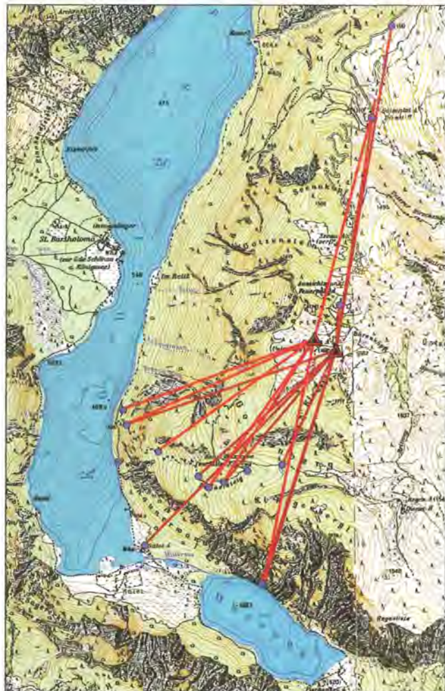
Abb. 3-27: Skizze des Ergebnisses des Markierungsversuches im Gebiet Gotzenalm. Interessant ist die radiale Entwässerung zu entlichen kleineren Quellen sowie der sehr rasche Farbdurchgang zur großen Karstquelle am Obersee. Aus: PLASSMANN 1998. Kartengrundlage: Ausschnitt aus der digitalen Fassung der Topografischen Karte 1 : 25.000. © Bayerisches Landesvermessungsamt.
