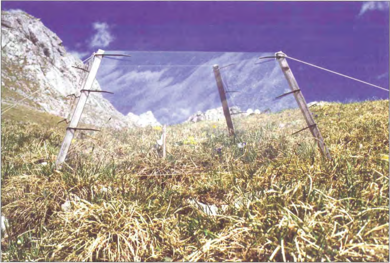
Abb. 24: Open Top Chamber (OTC) zur Erhöhung der Umgebungstemperatur der Pflanzen sowie der Oberbodentemperatur im Bereich des Horstseggenrasens.
