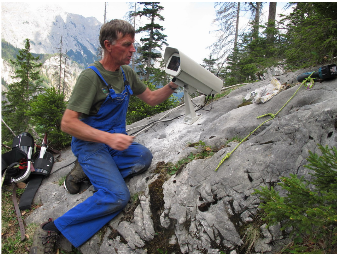
Abb. 29: Montagearbeiten der automatischen Kamera für Horst B5 H43 im Revier Klausbach – Quelle: NPV
