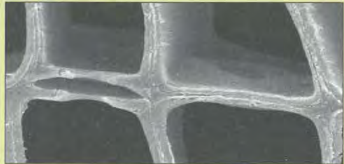
Elektronenmikroskopischer Blick in die Leitgefäße (Holzquerschnitt, Durchmesser der Gefäße ca. 25 Tausendstel Millimeter): Die Gefäße sind durch Öffnungen (Tüpfel) in den Zellwänden miteinander verbunden.
